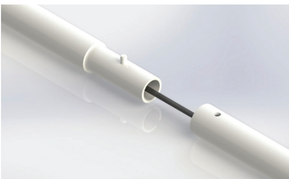
ภาพที่ 1 แสดงลักษณะวิธีการประกอบงานพิมพ์ โดยมีเชือกยึดหยุ่นนาร่อง ที่มา : ภาพจำลองโดยผู้วิจัย สุภาพณีย์ จันทร์หิรัญ
