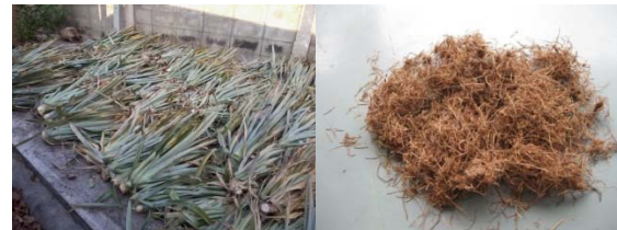
รูปที่ 1 ลักษณะทางกายภาพเส้นใยใบสับปะรด
