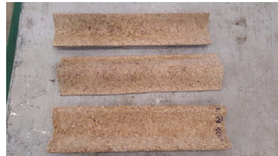
รูปที่ 11 ชิ้นส่วนที่ตัดและนำไปทดสอบสมบัติทางเชิงกล 12.5 มิลลิเมตร x 64.8 มิลลิเมตร
