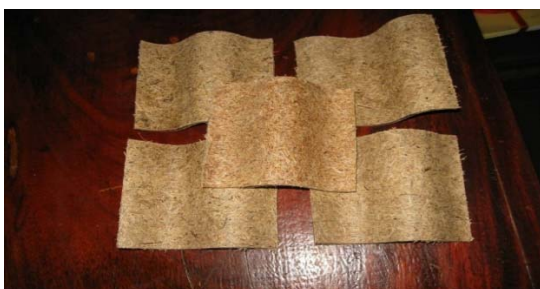
รูปที่ 7 ชิ้นส่วนที่ตัดและนำไปทดสอบสมบัติทางกายภาพขนาด 50 มิลลิเมตร x 50 มิลลิเมตร
