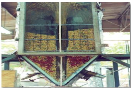
รูปที่ 9 เครื่องลดความชื้นข้าวเปลือกแบบสเปาเต็ดเบด [4]
