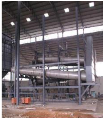
รูปที่ 7 เครื่องลดความชื้นข้าวเปลือกแบบโรตารี[1]
