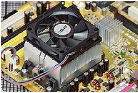
รูปที่ 1 ชูตครีประบายความร้อนและพัดลมติดตั้งบน ไมโครโปรเซสเซอร์
