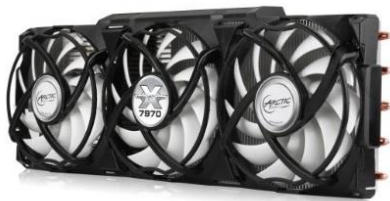
รูปที่ 2 ชูตครีประบายความร้อนพร้อมพัดลม 3 ชูต ติดตั้งบนกราฟิกการ์ด
