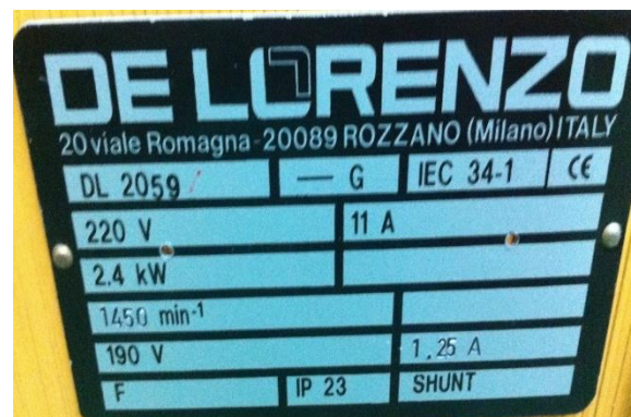
รูปที่ 8 Nameplate เครื่องกำเนิดไฟฟ้ากระแสตรง
