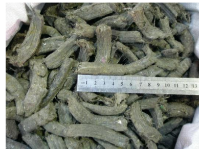
รูปที่ 3 เชื้อเพลิงขยะอัดแท่งจากหลุมฝังกลบ
