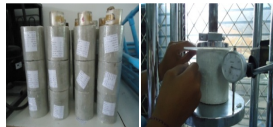
รูปที่ 3 การทดสอบกำลังรับแรงอัดแกนเดี่ยว
