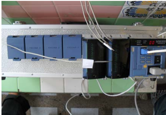
รูปที่ 12 เครื่องบันทึกข้อมูล Yokokawa MW-100
