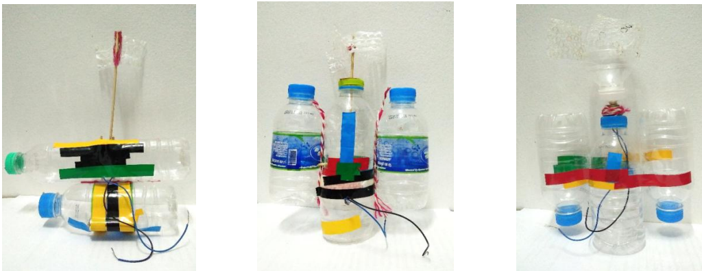
ภาพที่ 2 ตัวอย่างผลงานเครื่องเติมอากาศแบบทุ่นลอยของนักเรียน
