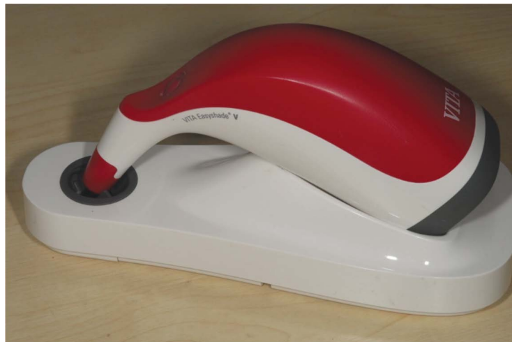
รูปที่ 3 เครื่องสเปกโตรโฟโตมิเตอร์ที่ใช้ในการศึกษาวิจัย
