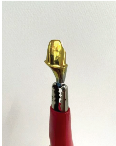
รูปที่ 2. รูปแสดงแอโนไดเซชันไทเทเนียมสีเหลือง Figure 2. Yellow anodized titanium abutment.
