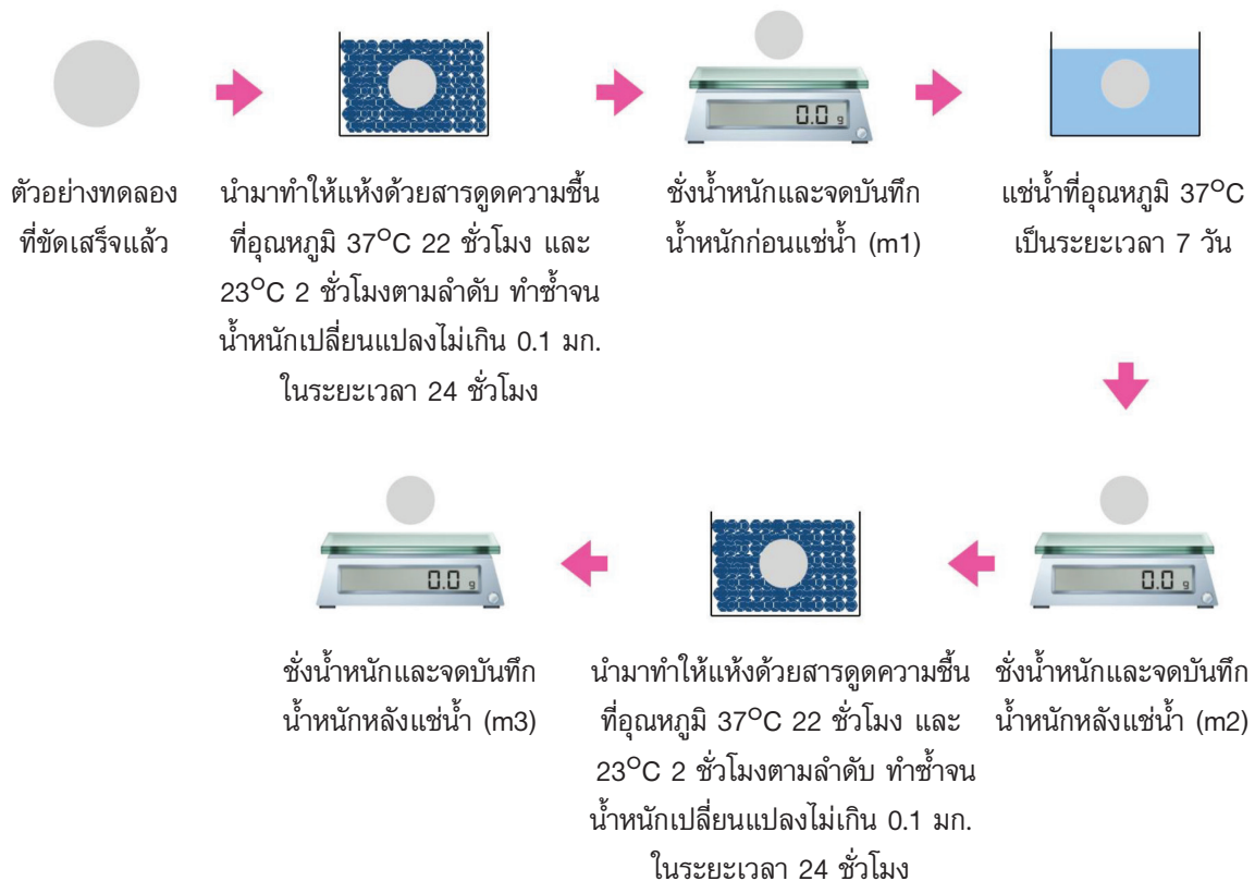
รูปที่ 2 ลำดับขั้นตอนในการทดสอบการดูดซับน้ำและการละลายตัวในน้ำ Fig 2. Flowchart of the water sorption and water solubility tests.
