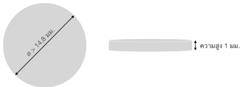
รูปที่ 1 ลักษณะตัวอย่างทดลองสำหรับทดสอบการดูดซับน้ำและการละลายตัวในน้ำ
