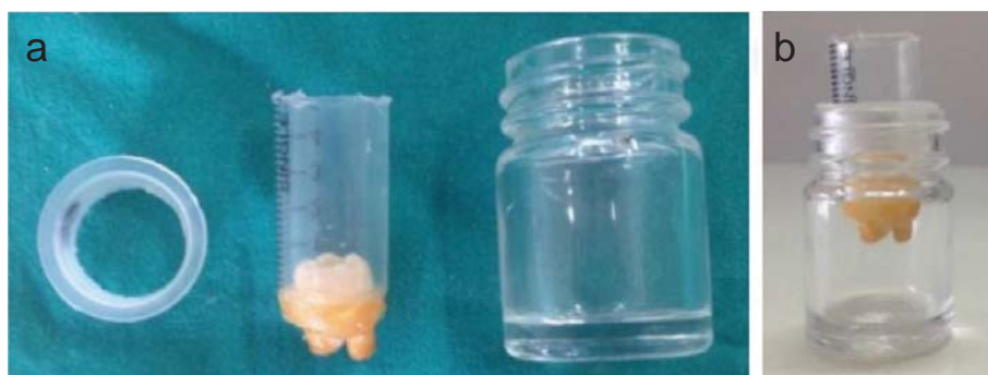
รูปที่ 2 a) อุปกรณ์ที่ใช้ทำแบบจำลองการรั่วซึมของโปรตีน b) แสดงการประกอบแบบจำลองการรั่วซึมของโปรตีน
