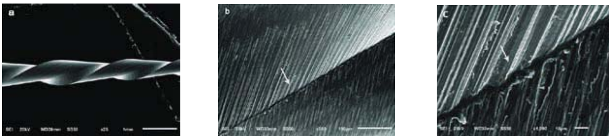
รูปที่ 1 ตัวอย่างเครื่องมือเรซิพรอคตัวหนึ่งที่คัดออกก่อนการใช้งานเมื่อตรวจด้วยกล้องจุลทรรศน์อิเล็กตรอนแบบส่องกราดที่กำลังขยายต่างๆ
