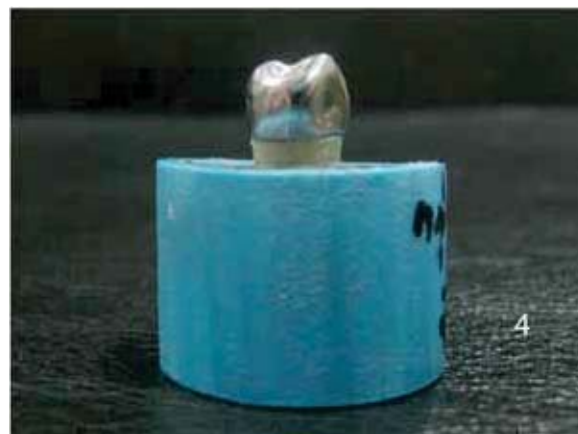
ภาพที่ 4 แสดงชิ้นงานภายหลังจากการยัดเดือยฟันโลหะเหวียงและครอบฟันโลหะด้วยซิงก์ฟอสเฟต ซีเมนต์ฝังในเบ้าอะคริลิก เรซิน
