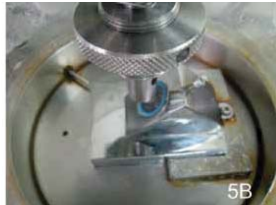
ภาพที่ 5A ภาพขณะที่ชิ้นงานกำลังถูกทดสอบแรงต้านทานการแตกหักด้วยเครื่องทดสอบสากลที่มุม 135 องศา
