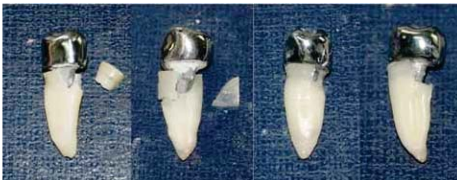
ภาพที่ 7 ชิ้นตัวอย่างในกลุ่มที่ 2, 3 (ไม่มีเฟอร์รูล) แตกที่ระดับรากใกล้คอฟัน
