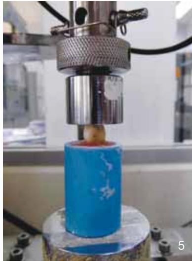
รูปที่ 5 ภาพขณะที่ฟันถูกแรงอัด ด้วยเครื่องทดสอบสากล
