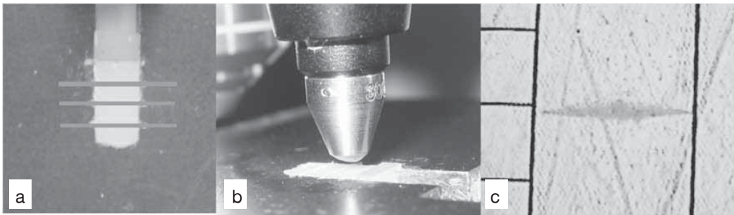
รูปที่ 4 การวัดค่าความแข็งผิวแบบนูน Figure 4. Knoop hardness measurement
