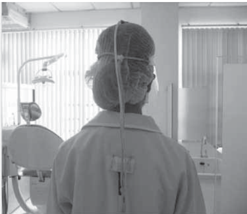
รูปที่ 2 การติดเซนเซอร์วัดความเอียงไว้ที่ตำแหน่งกลางศีรษะและที่ตำแหน่งกลางหลังส่วนบน
