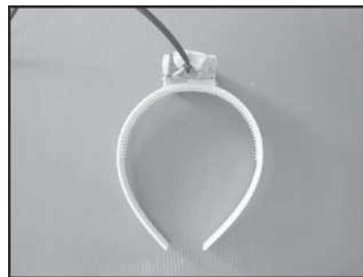
รูปที่ 5 การติดเซนเซอร์วัดความเอียงบนที่คาดผม
