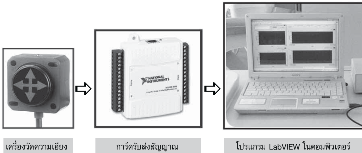
รูปที่ 3 ส่วนประกอบของเครื่องมือวัดเสมือนจริง
