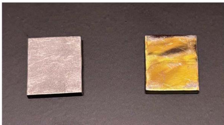
รูปที่ 2 แผ่นพื้นหลังไทเทเนียมที่ไม่ผ่านกระบวนการอโนไดซ์และไทเทเนียมที่ผ่านกระบวนการอโนไดซ์เป็นสีเหลือง
