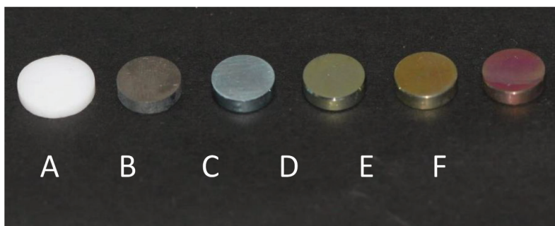
รูปที่ 1 วัสดุทำหลักยึดรากเทียม (A) เซอร์โคเนีย (B) ไทเทเนียม (C-F) ไทเทเนียมที่ผ่านกระบวนการอะโนไดซ์ด้วยกระแสไฟฟ้าหลายระดับ (40-70 โวลต์) Figure 1 Implant abutment materials (A) Zirconia (B) Titanium (C-F) Anodized titanium at various voltages (40-70 V).
