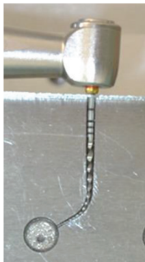
รูปที่ 1 การทดสอบความต้านทานความล้าจากการหมุนรอบในคลองรากฟันจำลองที่ประดิษฐ์ขึ้น
