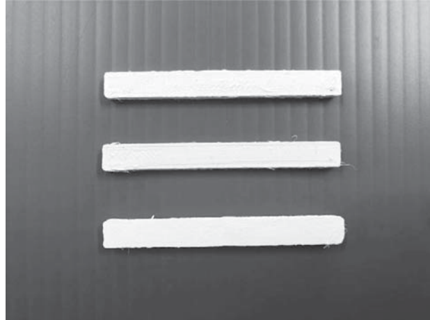
รูปที่ 4 ตัวอย่างชิ้นงานที่พิมพ์ด้วยเครื่องพิมพ์ 3 มิติ
