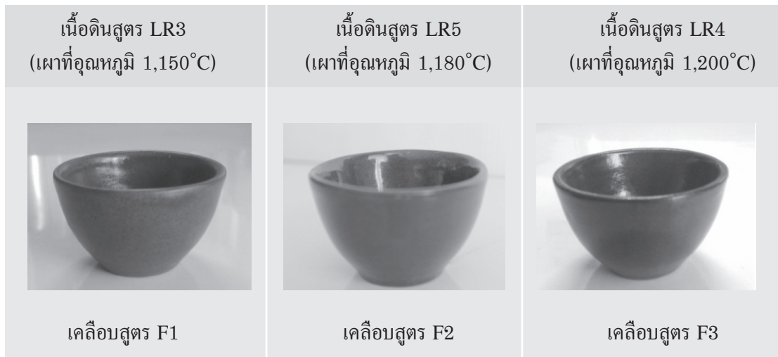
รูปที่ 4 ตัวอย่างผลิตภัณฑ์ที่ได้จากงานวิจัยการพัฒนาดินเหนียวกรุงเทพฯ เพื่อการผลิตเซรามิก
