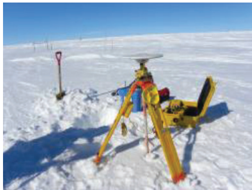
รูปที่ 14 การติดตั้งเครื่องมือ GPS เพื่อติดตามการเคลื่อนตัวของแผ่นน้ำแข็งบริเวณทวีปแอนตาร์กติก โดยในปัจจุบันพบว่าแผ่นน้ำแข็งมีการเคลื่อนตัวประมาณ 5 เมตรต่อปี (รูป: สุชนา ชวนิชย์)
