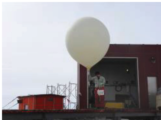
รูปที่ 10 การปล่อยบอลลูนเพื่อตรวจวัดค่าต่างๆ บนชั้นบรรยากาศ เช่น ทิศทางลม ความเร็วของลม ความชื้น อุณหภูมิ ความดัน ความหนาแน่นของโอโซน และก๊าซแอมโมเนีย เป็นต้น (รูป: สุชนา ชวนิชย์)
