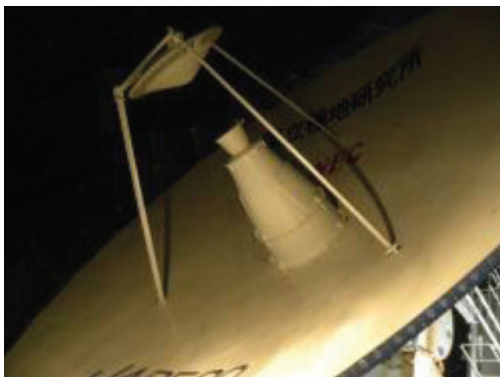
รูปที่ 15 งานรับดาวเทียมเพื่อใช้ในการศึกษาและติดตามการเคลื่อนตัวของเปลือกโลก (plate movement) ซึ่งสถานีโซวัวะเป็นสถานีที่อยู่ในโครงการเครือข่าย Very Long Baseline Interferometry (VLBI) (รูป: สุชนา ชวนิชย์)
