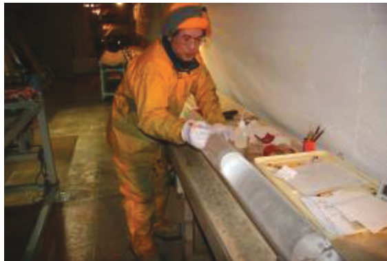
รูปที่ 9 แท่งน้ำแข็ง หรือ ice core ที่ขุดเจาะขึ้นมาได้จากที่ระดับความลึก 3,035 เมตร ซึ่งสามารถบอกถึงความเปลี่ยนแปลงของสภาพแวดล้อมบริเวณนั้นย้อนหลังไปในอดีตถึง 720,000 ปี (รูป: Hideaki Motoyama)
