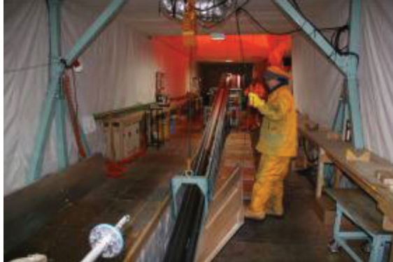
รูปที่ 8 การขุดเจาะแผ่นน้ำแข็งใต้สถานีวิจัยโดมฟูจิ (รูป: Hideaki Motoyama)
