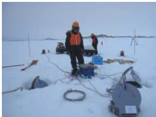
รูปที่ 22 ตรวจวัดก๊าซคาร์บอนไดออกไซด์บริเวณแผ่นน้ำแข็ง รวมทั้งเก็บตัวอย่างน้ำแข็งเพื่อตรวจวัดค่าคลอโรฟิลล์ อุณหภูมิ ความเค็ม และความเป็นกรดและด่าง (รูป: สุชนา ชวนิชย์)
