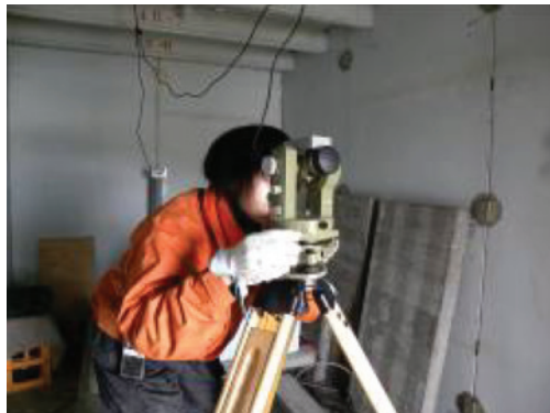
รูปที่ 7 เครื่องมือวัดสนามแม่เหล็ก ซึ่งมีการตรวจวัดเป็นประจำทุกเดือน (รูป: สุชนา ชวนิชย์)
