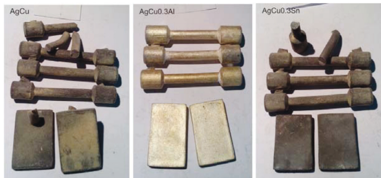
ภาพที่ 1 ชิ้นงานหล่อของโลหะเงินผสมทองแดง (AgCu) (ซ้าย) เงินผสมทองแดงที่เติมอะลูมิเนียม 0.3% (AgCu0.3Al) (กลาง) และเงินผสมทองแดงที่เติมดีบุก 0.3% (AgCu0.3Sn) (ขวา)
