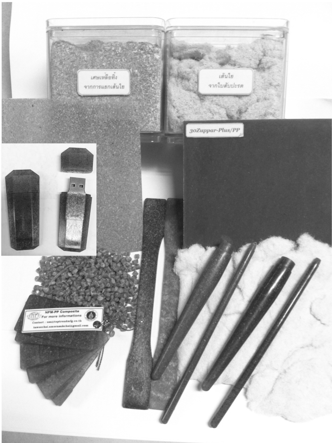
รูปที่ 5 ลักษณะปรากฏของชิ้นงาน และตัวอย่างผลิตภัณฑ์ที่ผลิตจากพอลิพรอพิลีน (PP) ผสมเส้นใยใบสับประรด (PALF) และส่วนที่ไม่ใช่เส้นใยซึ่งเป็นเศษเหลือทิ้งจากการแยกใบสับประรด (NFM)
