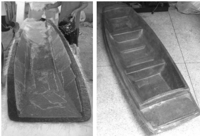
รูปที่ 9 การผลิตผลิตภัณฑ์ต้นแบบเรือไฟเบอร์จากแผ่นเส้นใยใบสับปะรดแบบที่ใช้ใบทั้งหมดและพอลิเอสเตอร์แบบไม่อมตัว โดยกระบวนการ hand lay-up ด้วยแบบ 2 ชั้น แล้วจึงนำมาประกบกันให้ได้ตัวเรือ
