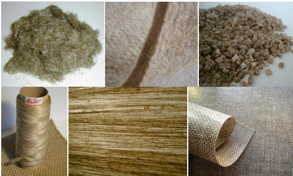
รูป 2 ตัวอย่างผลิตภัณฑ์กลางน้ำจากแฟลกซ์ สำหรับการแปรรูปเป็นผลิตภัณฑ์อื่นๆ ต่อไป เช่น เส้นใยสั้น (บนซ้าย) แผ่นเส้นใยแบบไม่ทอ (บนกลาง) เม็ดพลาสติก (บนขวา) เส้นใยยาว และผ้าฝ้ายสำหรับการเสริมแรงคอมพอสิต (ล่างซ้าย) แผ่นพรีเพอร์กชนิดเส้นใยเรียงตัวทางเดียวในอ็อกซี่ (ล่างกลาง) และแผ่นพรีเพอร์กชนิดผ้าทอ [4-5]
