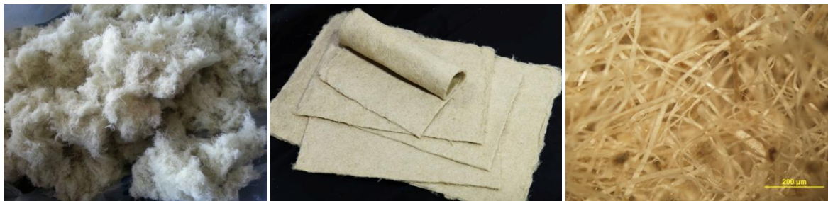
รูปที่ 4 ลักษณะของเส้นใยใบสับปะรดที่แยกด้วยวิธีการบดเชิงกล (ซ้าย) หลังจากการขึ้นเป็นแผ่นเส้นใยแบบไม่ทอ (กลาง) และภาพถ่ายจากกล้องจุลทรรศน์ของแผ่นเส้นใย (ขวา)
