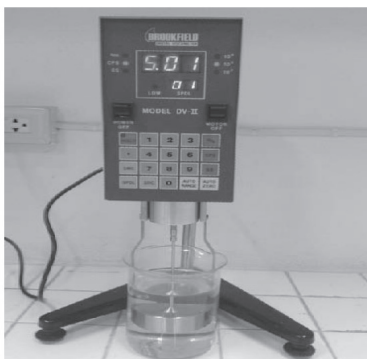
รูปที่ 3 แสดงมาตรวัดความหนืดชนิดหมุนแบบดิจิตอล (บรุคฟิลด์) ที่พร้อมใช้งานและหัววัดแต่ละขนาด
