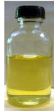
รูปที่ 2 ลักษณะที่มองเห็นด้วยตาเปล่าของไมโครอิมัลชัน: ประกอบด้วย Cetiol® OE 6.33% w/w, น้ำกลั่น 40.43% w/w, Plantacare® 2000UP 44.37% w/w และ Span® 20 8.87% w/w
