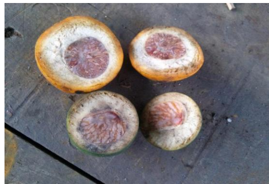
ภาพประกอบที่ 8 ภาพผลหมากที่ผ่าด้วยเครื่องตัดแยกขนาดและผ่าผลหมาก(ผ่าไม่เข้ากลาง)
