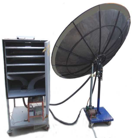
ภาพประกอบ 2 ด้านหน้าของเครื่องอบแห้งทบบนจานพาราโบลา และสะท้อนเข้าตัวรับรังสี โดยทำจากทองเหลืองที่หาง่ายตามท้องตลาดและสามารถนำความร้อนได้สูง
