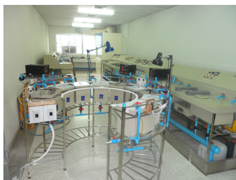
ภาพประกอบ 3 ถังล้างด้วยไฟฟ้า ถังชุบเงิน และชุบโรเดียม กับเครื่องแปลงกระแสไฟฟ้า
