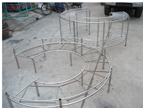
ภาพประกอบ 2 โครงสร้างชั้นส่วนบนและส่วนล่าง ถอดประกอบได้ มีชั้นใช้วางถังชุบและสารเคมีต่างๆ
