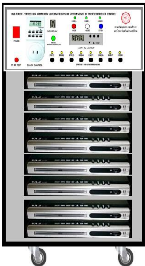
ภาพประกอบที่ 12 เครื่องควบคุมเครื่องเล่นดีวีดี โดยไมโครคอนโทรลเลอร์ PIC16F877 สำหรับระบบเคเบิลโทรทัศน์ท้องถิ่น
