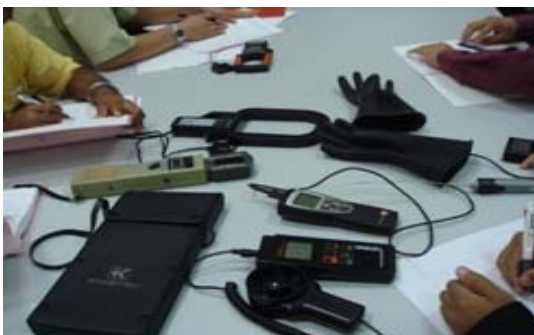
ภาพที่ 3 เครื่องมือตรวจวัดเบื้องต้นด้านพลังงาน
