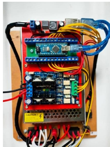
ภาพประกอบ 6 วงจรควบคุมการทำงานเครื่องบรรจุกาละแมกึ่งอัตโนมัติ
