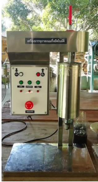
ภาพประกอบ 4 โครงสร้างเครื่องบรรจุกลูอะแมกิ้งอัตโนมัติ
