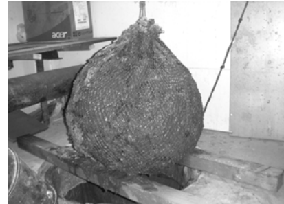
ภาพประกอบ 1 ตัวกลางขวดพลาสติกเหลือใช้ที่นำออกจากระบบบำบัดน้ำเสียแบบไม่ใช้ออกซิเจน
