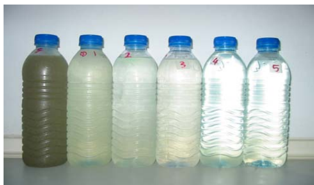
ภาพที่ 3 แสดงลักษณะทางกายภาพของ น้ำก่อนการบำบัด น้ำที่ใช้เวลาทำการบำบัด 0.5, 1.0 ,1.5, 2.0 และ 2.5 ชั่วโมง ตามลำดับ เรียงจากซ้ายมาขวา
