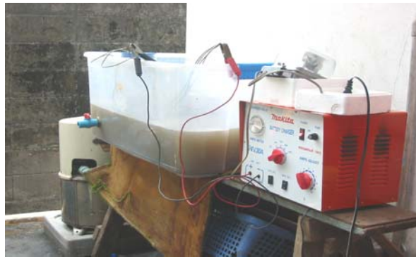
ภาพ 1 แสดงการจัดวางอุปกรณ์การบำบัดน้ำเสีย โดยกระบวนการอิเล็กโทรลิซิส
