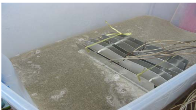
ภาพที่ 2 แสดงการต่อแหล่งจ่ายไฟฟ้ากับแผ่นอิเล็กโทรดแบบโมนิโพลาร์แบบขนานซึ่งกำลังทำการบำบัดน้ำเสีย
