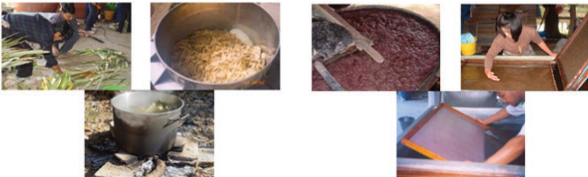
ภาพที่ 1 การเตรียมวัตถุดิบ และการต้มเยื่อ (ซ้าย), การฟอกข้อมสีเยื่อ การกระจายเยื่อ และการทำแผ่นกระดาษ (ขวา) ที่มา : กลุ่มวัสดุธรรมชาติและเส้นใย กองวัสดุวิศวกรรม. (2560). การทำกระดาษจากวัตถุดิบในท้องถิ่น (Making Paper From Local Raw Material). เอกสารประกอบการบรรยายของกองวัสดุวิศวกรรม, กรุงเทพฯ : กองวัสดุวิศวกรรม กรมวิทยาศาสตร์บริการ
