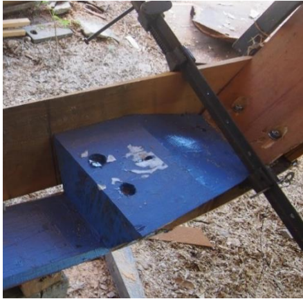
ภาพที่ 12 โป๊ะหัว โป๊ะท้ายเรือส่วนที่เชื่อมต่อหัวเรือท้ายเรือกับกระดูกงู ที่มา ภาพถ่ายโดยผู้วิจัย เมื่อวันที่ 6 กันยายน 2558
