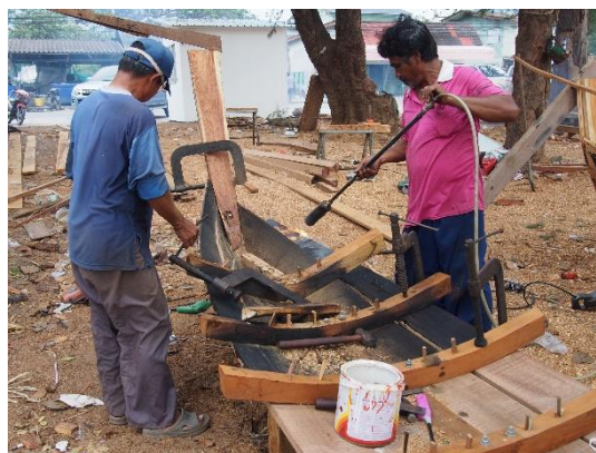
ภาพที่ 7 การดัดแผ่นไม้กระดานให้โค้งโดยใช้ความร้อน โดยใช้หัวเป่าแก๊ส ที่มา : : ภาพถ่ายโดยผู้วิจัย เมื่อวันที่ 18 มีนาคม 2558
