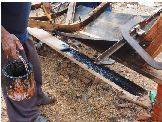
ภาพที่ 6 ทาน้ำมันเครื่องให้แล้ว เพื่อป้องกัน ไม้ให้ไม้ไหม้ไฟก่อนนำไฟมาลน ที่มา : : ภาพถ่ายโดยผู้วิจัย เมื่อวันที่ 18 มีนาคม 2558
