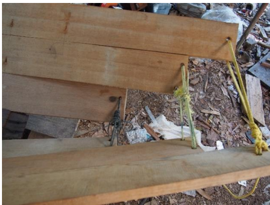
ภาพที่ 9 การตัดไม้กระดานให้โค้งโดยใช้เชือก ที่มา : ภาพถ่ายโดยผู้วิจัย เมื่อวันที่ 24 มิถุนายน 2558
