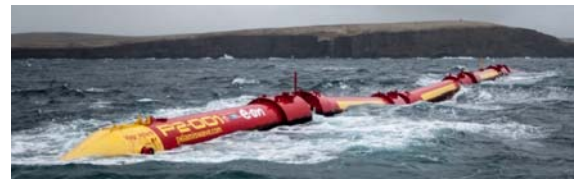
รูปที่ 1 เครื่องกำเนิดไฟฟ้า Pelamis [11]
