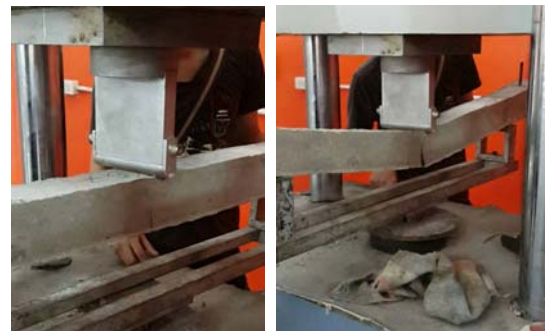
รูปที่ 18 ตัวอย่างการทดสอบคอนกรีตเสริมไม้ไผ่ธรรมชาติเมื่อเริ่มร้าวและขาด
