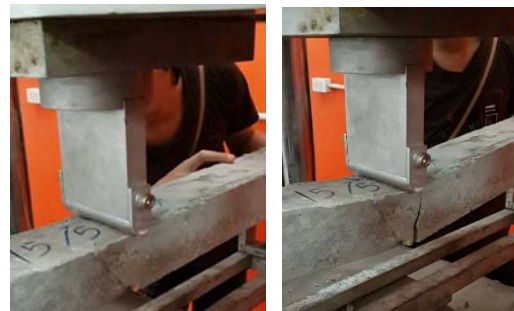
รูปที่ 19 ตัวอย่างการทดสอบคอนกรีตเสริมไม้ไผ่รีดเย็นบิดเกลียวตัดออกจากฐานยึดที่ 48 ซม
