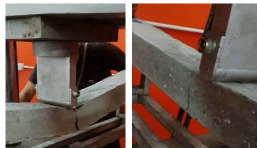
รูปที่ 20 ตัวอย่างการทดสอบคอนกรีตเสริมไม้ไผ่รีดเย็นบิดเกลียวตัดออกจากฐานยึดที่ 72 ซม
