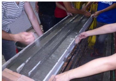
รูปที่ 15 การเทคอนกรีตลงในแบบโดยการแบ่งช่องสามช่อง
