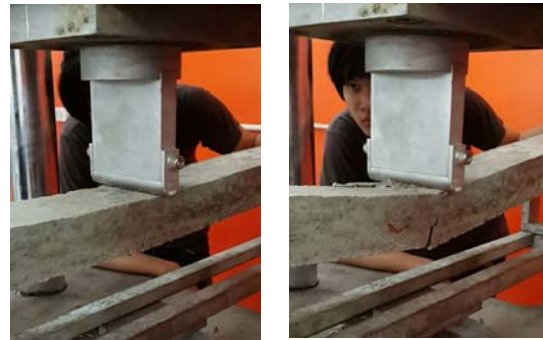
รูปที่ 17 การทดสอบคอนกรีตเปล่าขณะที่คอนกรีตเริ่มแตก
