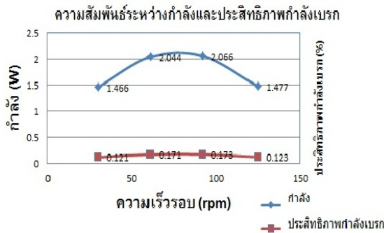
รูปที่ 7 แสดงความสัมพันธ์ระหว่างกำลังและประสิทธิภาพกำลังเบรก
