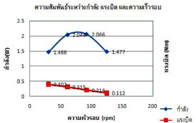
รูปที่ 6 แสดงความสัมพันธ์ระหว่างความเร็วรอบ กำลัง และแรงบิด
