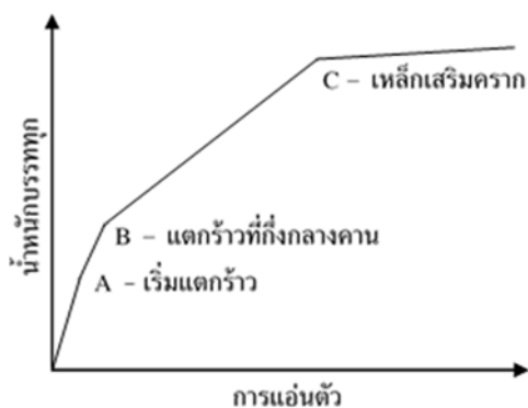
รูปที่ 13 พฤติกรรมการแอ่นตัวของคานคอนกรีตที่ เสริมเหล็กต่ำกว่าสมดุลง (under-reinforced) [8]
