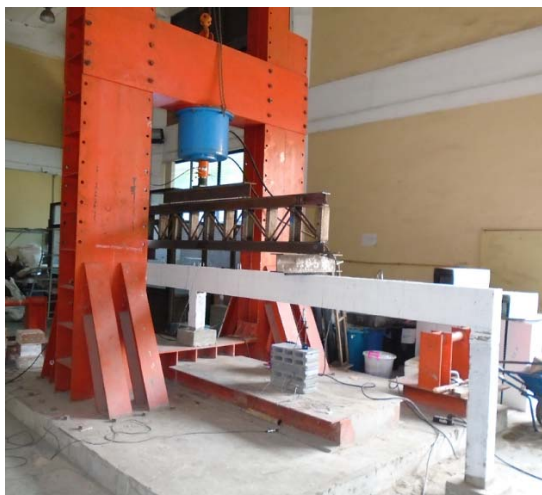
รูปที่ 7 การติดตั้งเครื่องมือบนตัวอย่างทดสอบ
