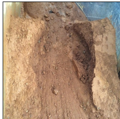
รูปที่ 7 ตัวอย่างคันดินที่เกิดการกัดเซาะคงที่
