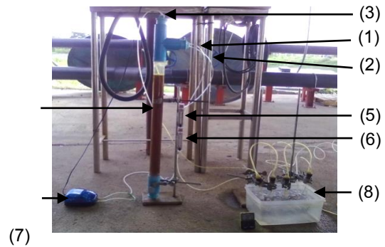
รูปที่ 1 ชุดกำจัดก๊าซไฮโดรเจนซัลไฟด์ ประกอบด้วย (1) ทางเข้าของก๊าซชีวภาพ (2) ทางเข้าของอากาศ (3) ทางออกของก๊าซ (4) คอลัมน์บรรจุสารละลายเหล็ก (III) อีดีทีเอ (5) โรตاميเตอร์ของก๊าซชีวภาพ (6) โรตاميเตอร์ของอากาศ (7) เครื่องพ่นอากาศ และ (8) ชุดวัดก๊าซไฮโดรเจนซัลไฟด์
