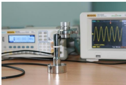
รูปที่ 5 การเชื่อมต่อระบบโซโนโพเลชั่นสำหรับการทดสอบย่านความถี่
