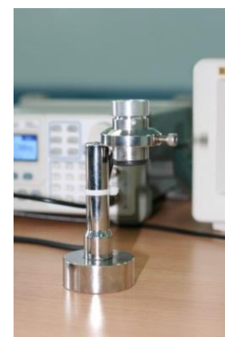
รูปที่ 4 อุปกรณ์ต้นแบบโซโนโพเลชัน (prototype of sonoporation device)
