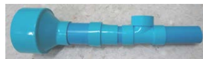
รูปที่ 6 ตัวกรองอะคูสติกส์ความถี่สูงผ่านที่สร้างขึ้นอย่างง่ายด้วยท่อ PVC
