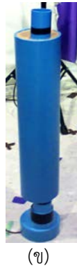
รูปที่ 7 (ก) โครงสร้างของท่อลดทอนเสียงชนิด Three-duct muffler และ (ข) ท่อลดทอนเสียงชนิด Three-duct muffler อย่างง่ายที่สร้างขึ้นโดยใช้ PVC
