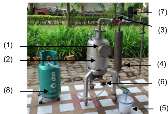
รูปที่ 1 เครื่องปฏิกรณ์ไพโรไลซิสประกอบด้วย (1) ทางป้อน (2) ส่วนไพโรไลซิส (3) ช่องระบายแก๊ส (4) ส่วนควบแน่น (5) จุดเก็บผลิตภัณฑ์ (6) เต้าแก๊ส (7) เครื่องวัดอุณหภูมิ และ (8) ถังแก๊ส
