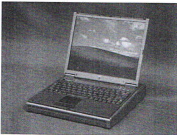
เครื่องคอมพิวเตอร์ Notebook ของ NEC ที่ใช้เซลล์เชื้อเพลิงแบบเมมเบรนแลกเปลี่ยนโปรตอน แทนแบตเตอรี่ จ่ายไฟได้สูงสุด 24 วัตต์ สามารถทำงานติดต่อกันได้นาน 5 ชั่วโมง
