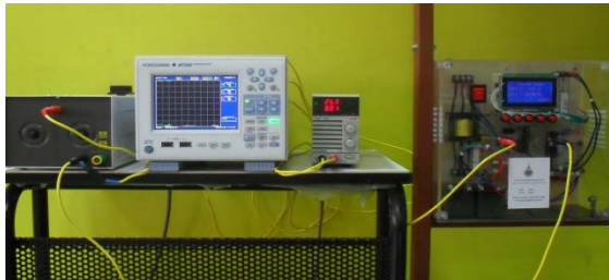
รูปที่ 10 การทดสอบเครื่องเมื่อใช้โหลดตัวต้านทาน
