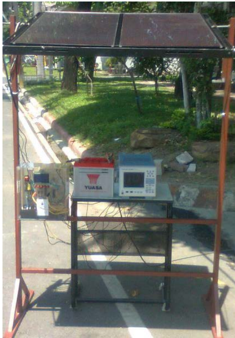
รูปที่ 14 การอัดประจุแบตเตอรี่โดยใช้แผงเซลล์แสงอาทิตย์ขนาด 30 W จำนวน 2 แผงต่อแบบขนาน
