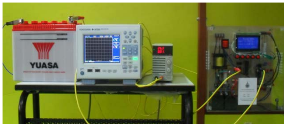
รูปที่ 12 การทดลองประจุแบตเตอรี่โดยใช้แหล่งจ่าย ไฟฟ้ากระแสตรงอัดประจุแบตเตอรี่ที่พิกัดกระแสใน การอัดประจุสูงสุด 5 A แรงดัน 14.5 V
